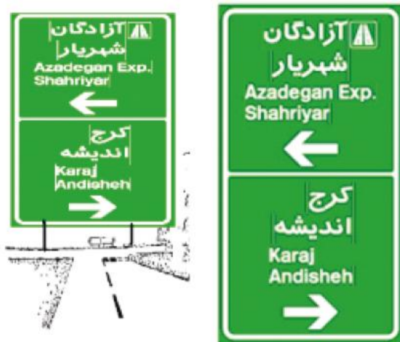
شکل الف-۶- نحوه نصب تابلوهای راهنمای مسیر در تقاطع های T شکل
