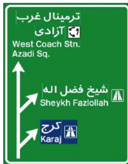
شکل ۹- نحوه رنگ‌بندی در هدایت به سمت آزادراه در تابلوی راهنمای مسیر بزرگراهی
